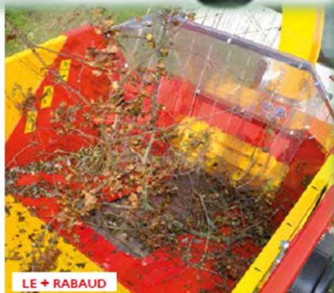
Rouleau ameneur surdimensionné et à pas convergents. Tapis ameneur avec crochets pour plus de confort d'utilisation. Capot transparent sur la trémie pour plus de visibilité.
