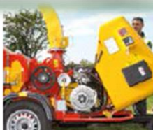
Capot en polyester pour un accès facile aux organes de la machine.
