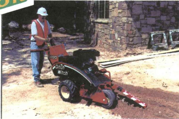
La 1330HE est une trancheuse de 13 hp, moteur Honda essence, refroidissement par air, conduite accompagnée, avancement et transmission hydraulique sur l'outil. Démarreur électrique. Compteur horaire.
