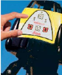
Utilisation en mode manuel pour régler une pente jusqu'à 10%
